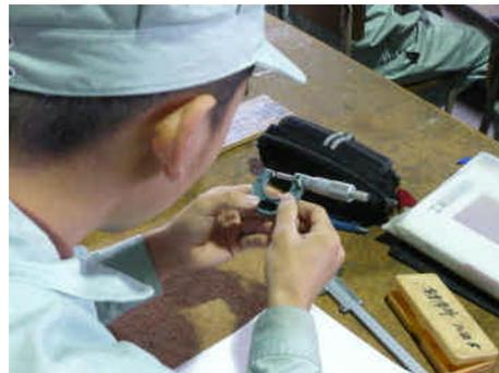
測定物に正しく当て、ラチェットストップを回して測定する。
